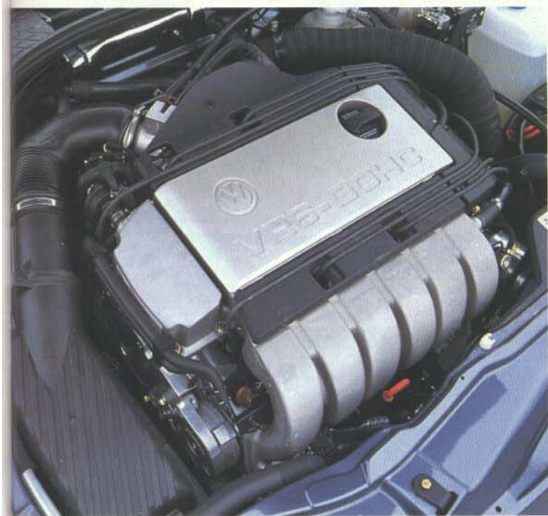
Oben: Viele finden an der Form des Corrado (rechts) den größeren Gefallen. Links: Der VR6 des VW mit 190 PS
