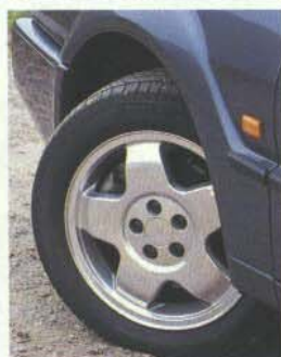
Links: Optimaler Fahrerplatz im VW. Oben: 205er Reifen auf 6,5-Zoll-Felge
